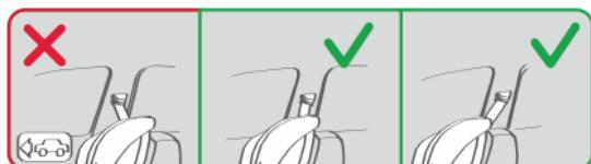
В весовой группе I, при установке автокресла с помощью 3-х точечного ремня безопасности автомобиля, необходимо проследить, чтобы верхняя точка крепления штатного ремня безопасности автомобиля находилась на уровне или позади детского кресла.
