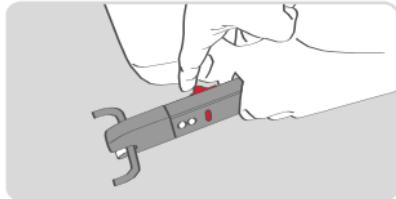
➤ Чтобы снять с сиденья автомобиля автокресло, отстегните крепления FIX, нажав на кнопки красного цвета, расположенные на внутренних боковых частях креплений FIX.
